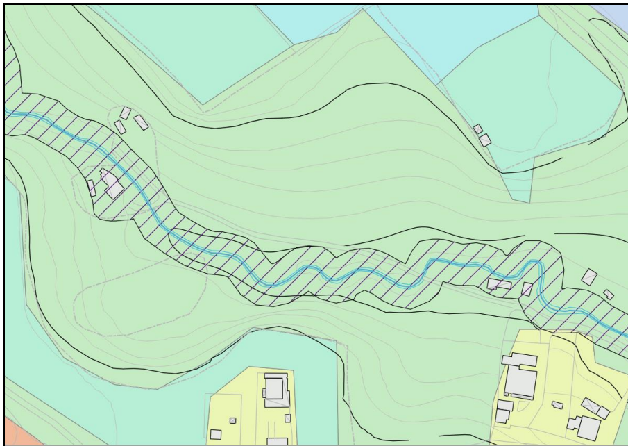
Fig. 13.8 - Sovrapposizione tra le aree PGRA proposte (barrato viola scuro aree P3H) e le classi d'uso così come riportate nel DUSAF 2022 per la valle del Luf. Si osserva che quantunque il corso d'acqua sia interamente compreso nella classe d'uso "boschi di latifoglie a densità media e alta governati a ceduo" sono presenti alcune costruzioni nell'area a pericolosità P3H.
