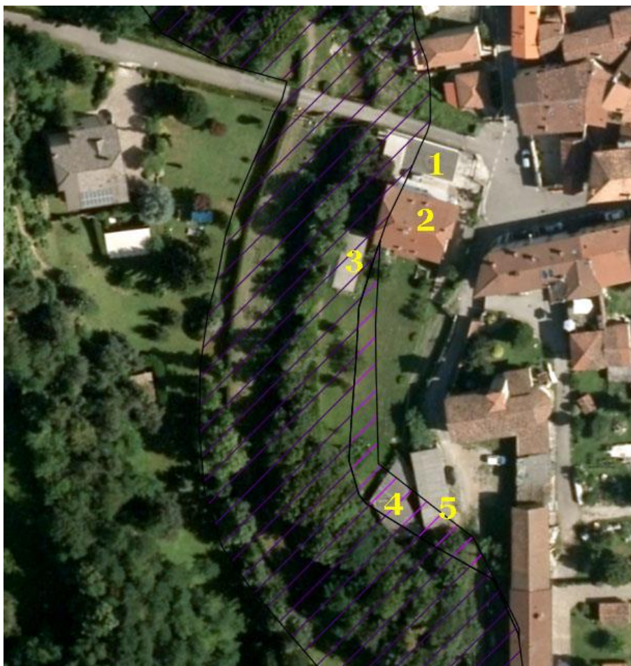
Fig. 13.22 - Porzione settentrionale del tratto Ponte di via Mercato-ponte di via Medolago. In barrato viola chiaro le aree P2/M, in barrato viola scuro quelle P3/H. Per la spiegazione dei numeri, vedi testo.
