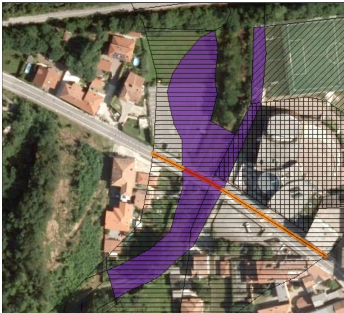
Fig. 3.4 - Elementi a rischio R4 (in viola), nella zona dalla ferrovia fino a poco a Sud del ponte di Via Milano.
