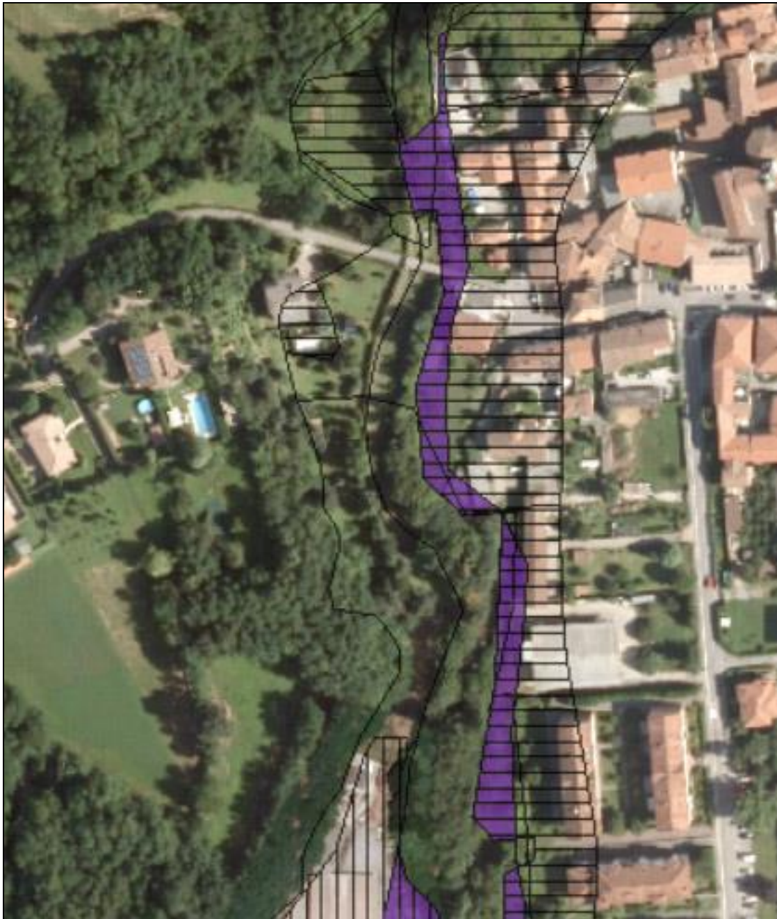
Fig. 3.5 - Aree a rischio R4 (in viola), nella zona dalla in vicinanza di via Mercato. Si osserva come esse siano estese per lo più in sponda sinistra ad eccezione di una piccola area in sponda destra appena a Nord del ponte di via Mercato.
